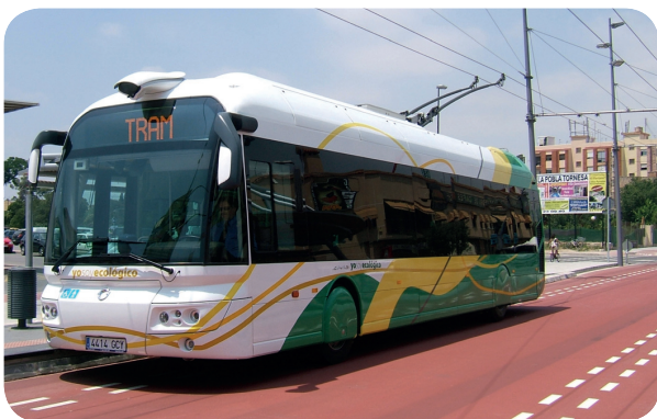
Bild 1: Anhand von Fahrbahnmarkierungen steuert Siemens Optiguide den Bus automatisch auf weniger als 5 cm an die Haltestelle heran.
