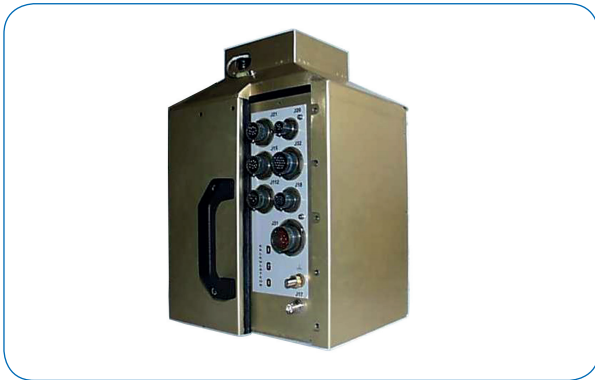
Bild 3: Der Steuerungscomputer basiert auf dem PC/104-Plus SBC Kontron MICROSPACE® MSM800SEL sowie dem Framegrabber MICROSPACE® MSMG104.
